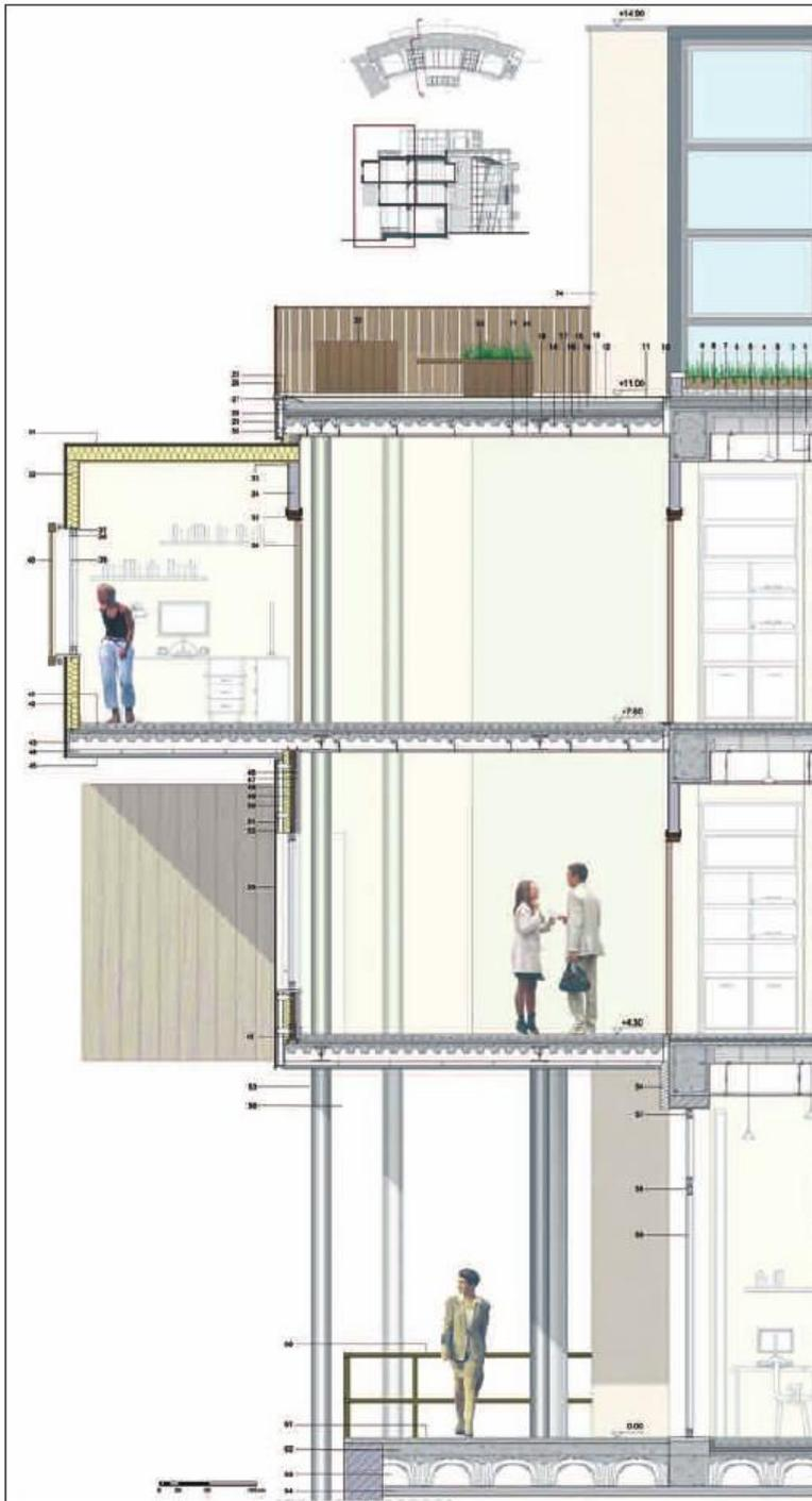
Sezione: tetto giardino, parete in pannelli prefabbricati, parete ventilata con rivestimento in legno. Viste tridimensionali dell'esterno e degli interni.
